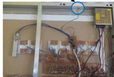
Gambar 2. Bingkai Aluminium Sebagai Peredam Panas ( Heat Sink )
