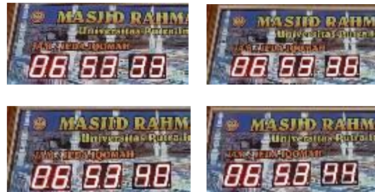
Gambar 5. Pengujian Tampilan Seven Segment Waktu (jam, menit, detik)
